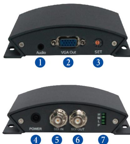
1. 模拟立体声音频输出 2. VGA 视频输出 3. 输出设置
