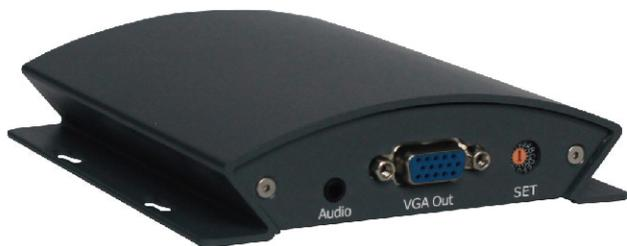
VC-STG-311是一款专用的 SDI 信号至 VGA 转换器,支持帧率转换,可将 3G/HD/SD-SDI 信号转为 VGA 视频信号。同时还可将 3G/HD/SD-SDI 信号中的音频解嵌处理,通过模拟立体声接口输出。
