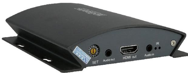
VC-STH-311是一款专用的SDI信号至HDMI转换器，支持帧率转换，可将3G/HD/SD-SDI信号转为HDMI高清视频信号。同时还可将SDI信号中的音频解嵌处理，通过HDMI接口或模拟立体声接口输出。
