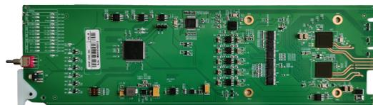
IMP-UDX-3040前插模块自带LED指示灯及控制按键，可实现功能模块的状态查看及参数配置，配合平台的网络控制模块，可通过上位机对功能模块进行集中管理和控制。同时该功能模块自带网络控制接口，无需平台网络控制模块也可通过web实现功能模块的状态查看及参数配置。
